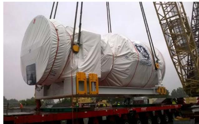
Construite à l'usine General Electric de Belfort, une turbine de 380 tonnes a été transportée sur automoteur de Strasbourg à Bouchain en moins d'une semaine.
