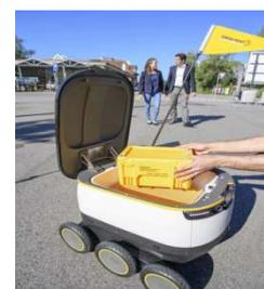
Equipés de multiples capteurs, d'un GPS et de caméras couplées à des technologies de reconnaissance visuelle, ces robots naviguent de façon autonome en évitant automatiquement les obstacles, grâce à quatre détecteurs frontaux. Les caméras intégrées devraient aussi pouvoir prendre en photo les éventuels voleurs, précise Dieter Bambauer.
